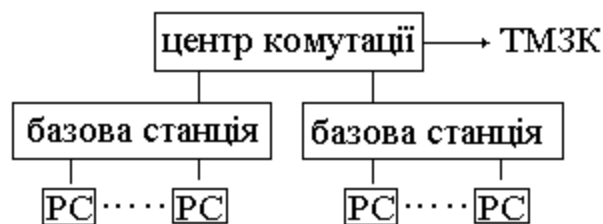
Рисунок 8.2 – Спрощена функціональна схема системи стільникового зв'язку
