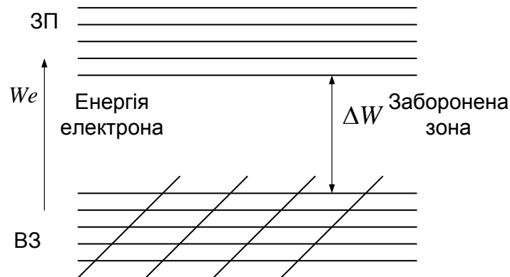
Рисунок 2.2 – Енергетична діаграма напівпровідника
