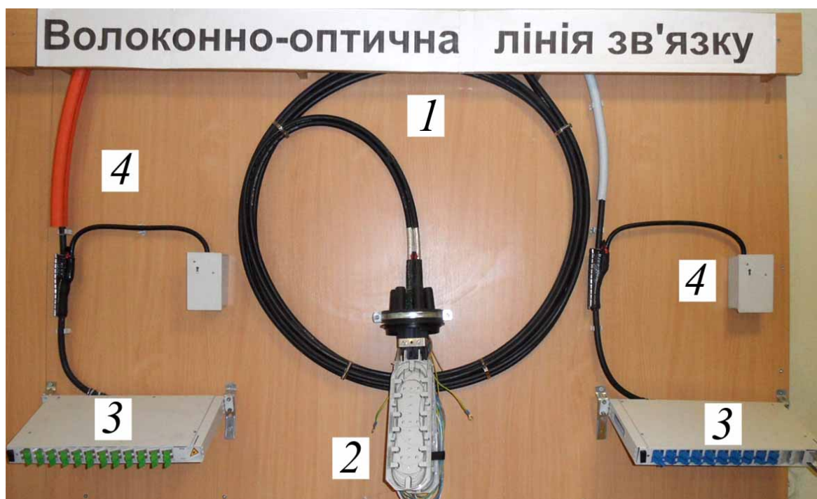
Рисунок 1 – Волоконно-оптична лінія зв'язку: 1 – оптичний кабель; 2 – оптична муфта; 3 – оптична комутаційна панель; 4 – засоби захисту лінії від негативних впливів
