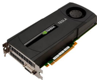
Рис. 2. Прискорювач GPGPU Tesla C2070 з підтримкою CUDA
