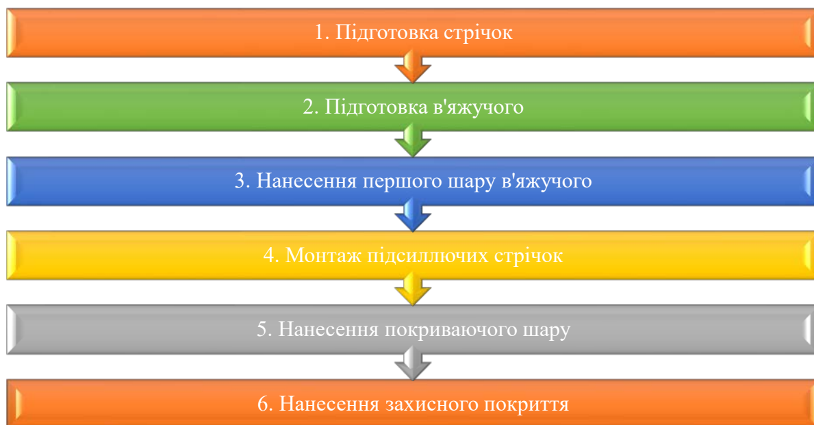
Рис. 1 – Виробництво робіт з підсилення конструкцій вуглецевими стрічками
