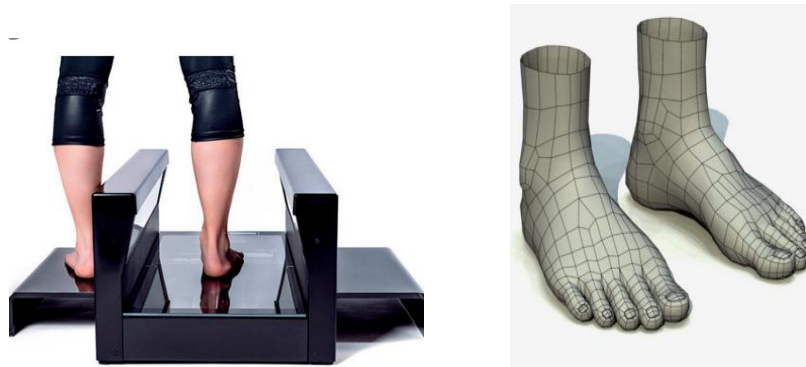
Рис. 1. Зображення 3D сканера ніг та отримана тривимірну модель
