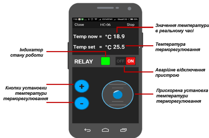
Рисунок 2 – Bluetooth інтерфейс програми керування лабораторним макетом
