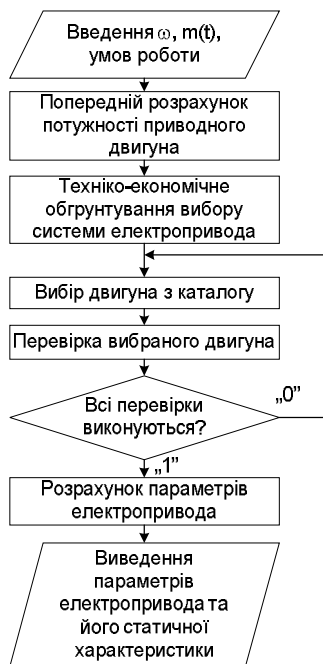
Рисунок 1 – Алгоритм розрахунку та вибору двигуна
