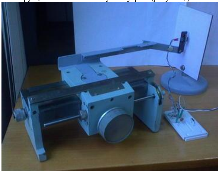
Рис.3.Лабораторна установка для дослідження відбивних властивостей оптопарі
