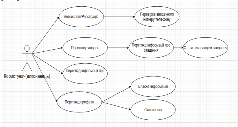
Рис.1. Діаграма варіантів використання для виконавця
