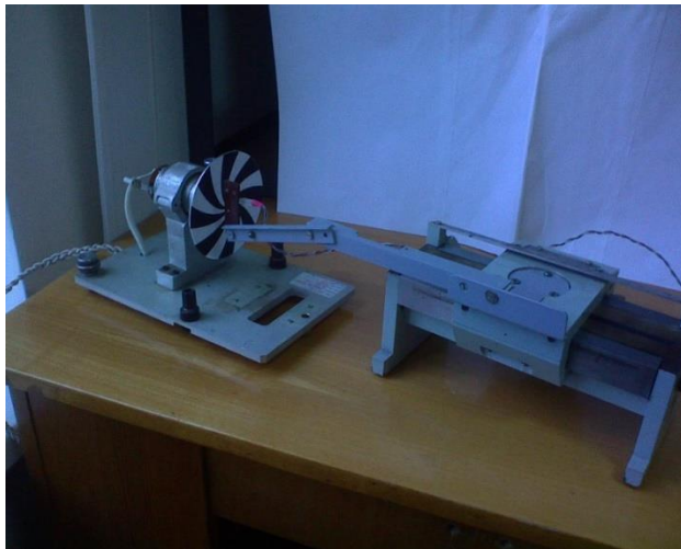
Рис. 1. Лабораторна установка для дослідження тахометричного перетворювача на базі відбивної оптипари
