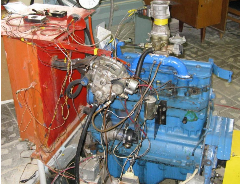
Дизель Д-240, переобладнаний для роботи на ПГ
