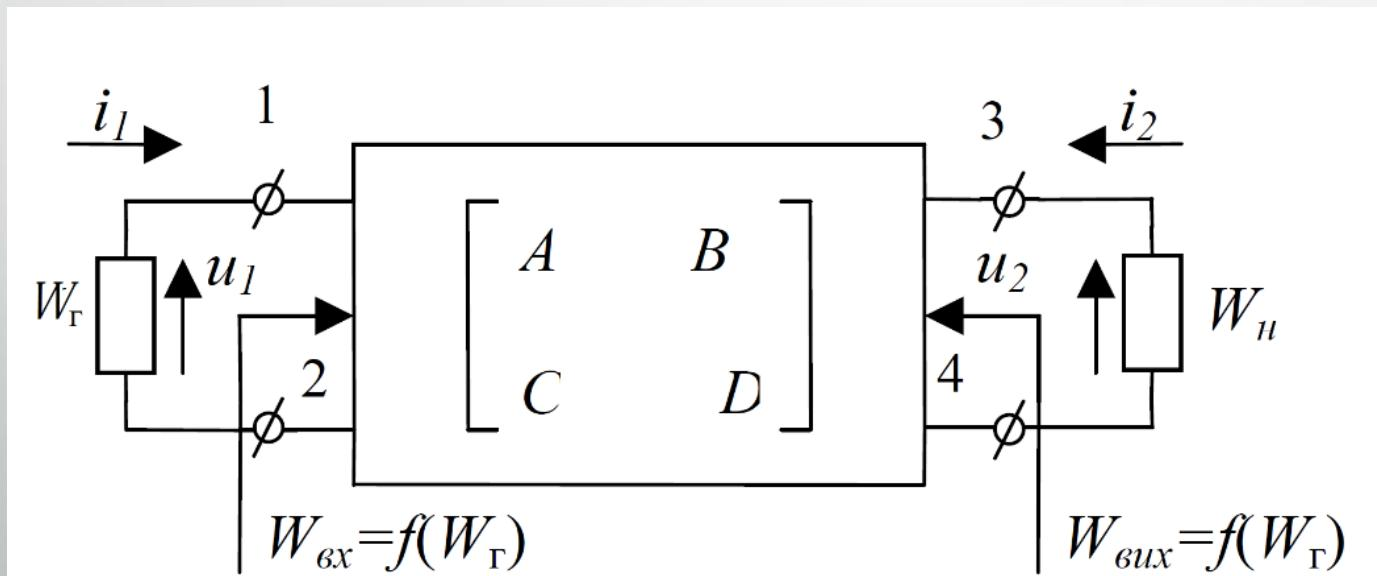
Лінійні чотириполюсники НВЧ діапазону описуються матрицею передачі [T], яка зв'язує сигнали на вході і виході об'єкту, або матрицею розсіювання [S], яка зв'язує розсіюванні від об'єкту сигналі.
