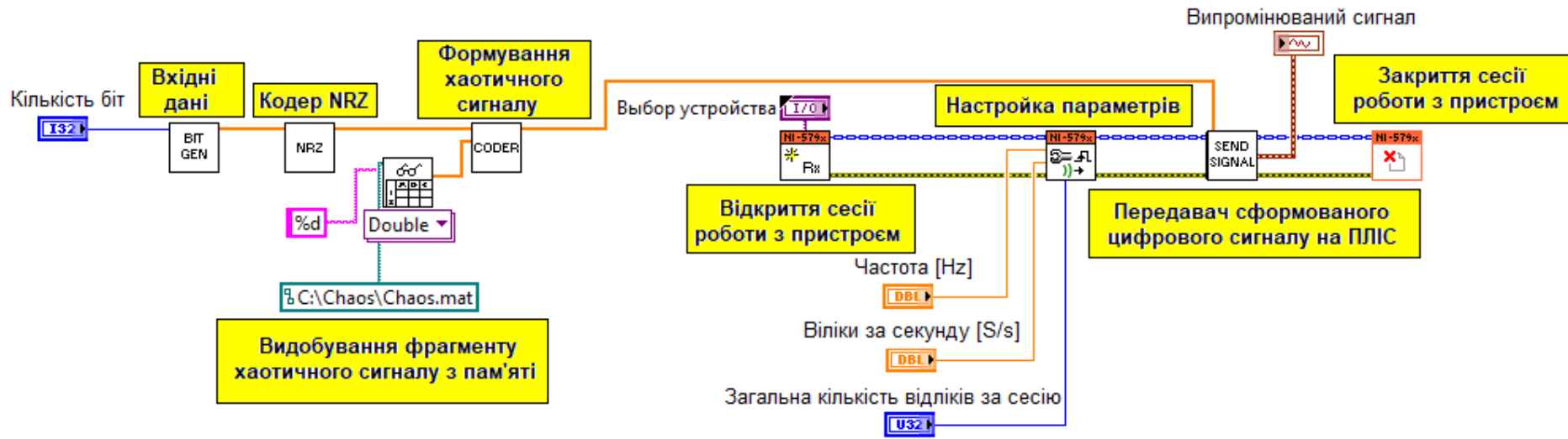
Рисунок К.2 – Структурна схема хаотичного приймача в середовищі LabView
