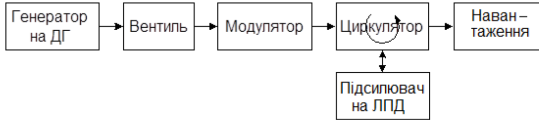
Рис. 1. Електрична структурна схема мікрохвильового керованого за частотою генератора на діоді Ганна
