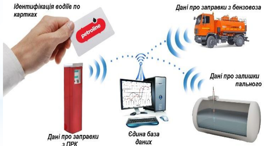
Система дистанційного контролю за рівнем палива у автомобілі
