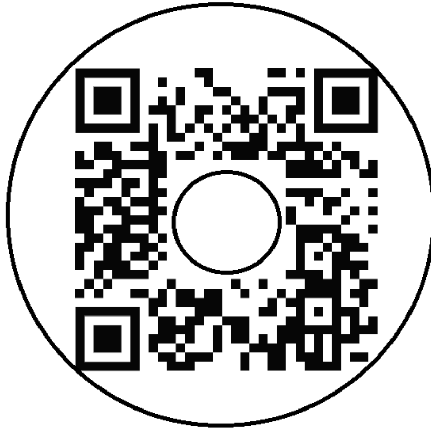
QR код для позиціонування БПЛА на рамі
