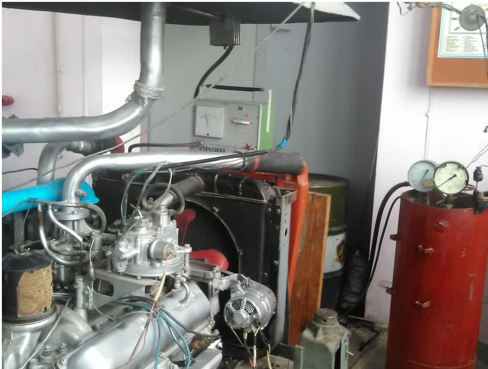
Загальний вигляд експериментальної установки для дослідження двигуна ЗМЗ-53А на різних видах палива
