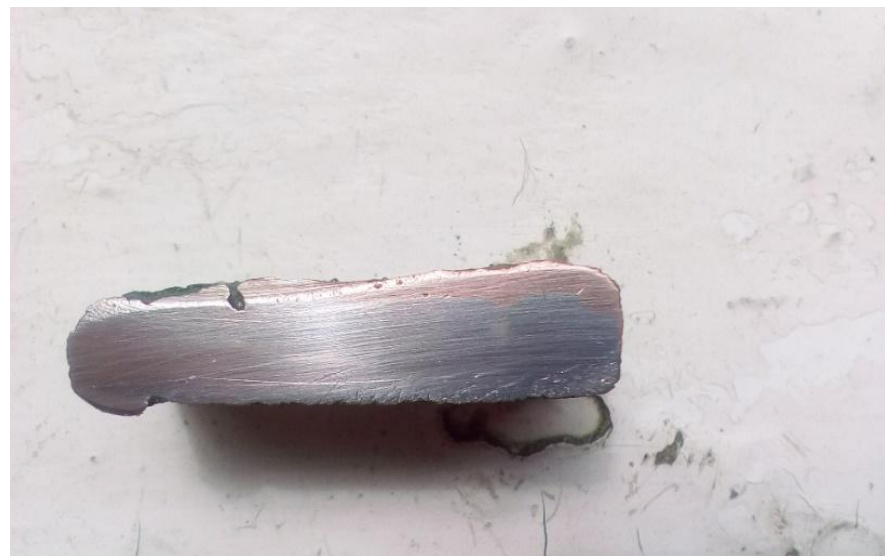
Рисунок 7 – Макрошліф зразка наплавленого за допомогою TIG
