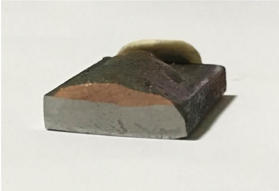
Рисунок 12 – Зразки наплавлені автоматичним способом в середовищі аргону
