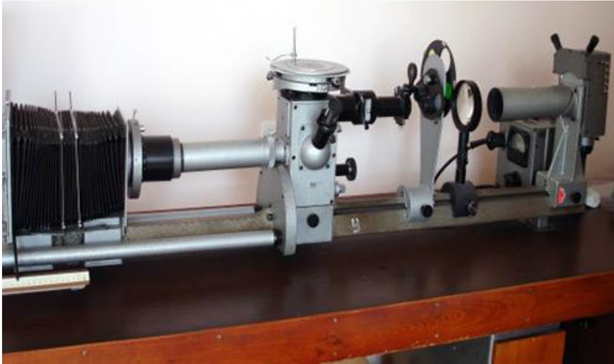
Рисунок 13 – Оптичний мікроскоп МИМ-8 та цифрова камера Sigeta UCMOS 5100
