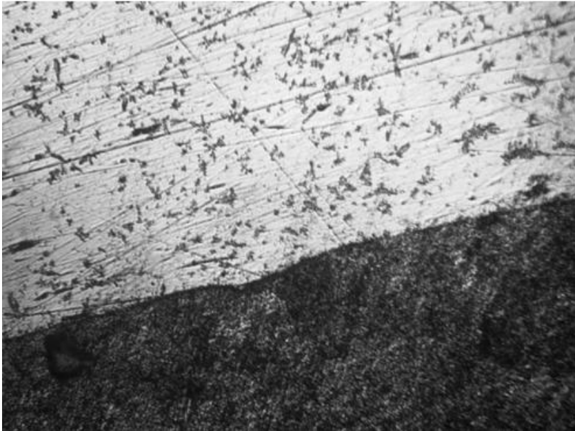
Рисунок 14 – Границя сплавлення основного металу з наплавленим
