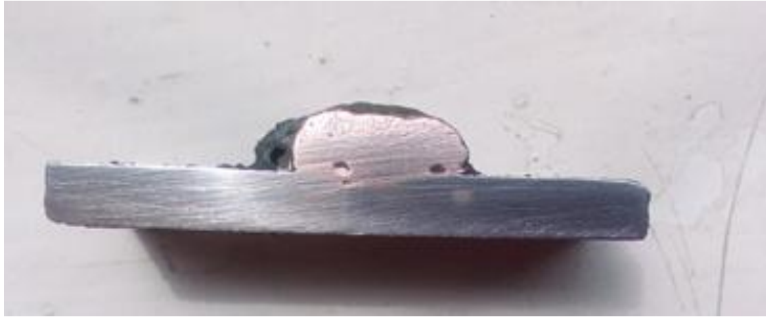
Рисунок 10 – Зріз наплавленого зразка за допомогою РДЗ
