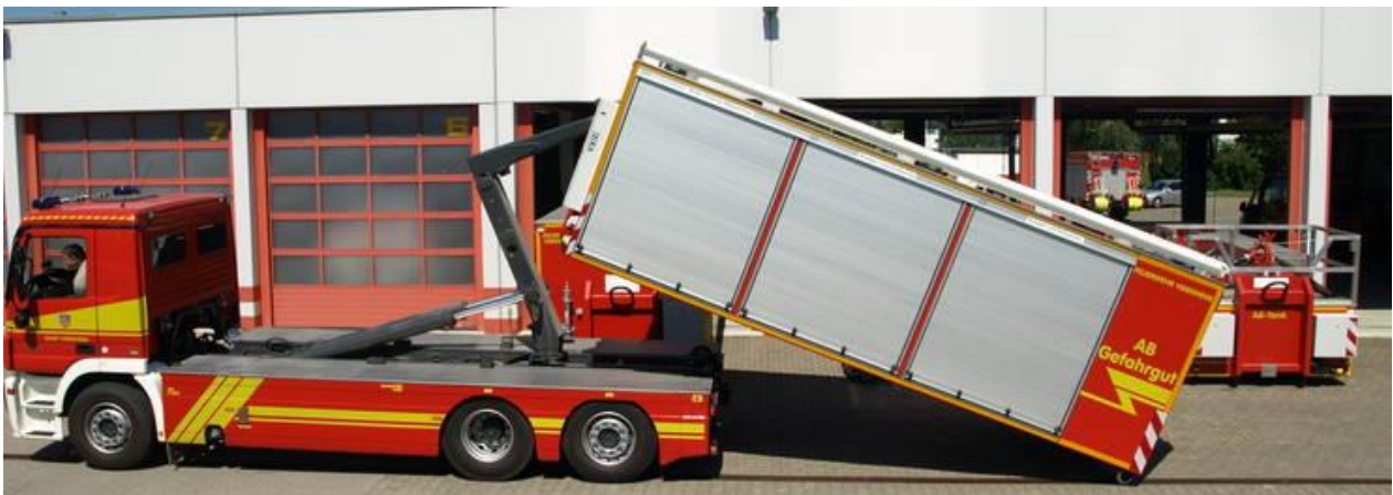
Рисунок 1 – Автомобіль-носіїв зі знімним кузовом-контейнером
