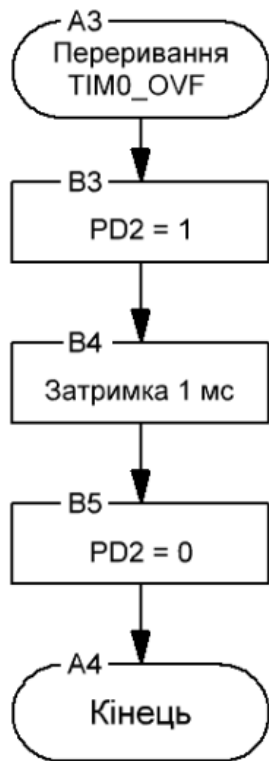
Алгоритм переривання при переповненні TC0
