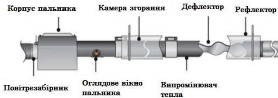
Рисунок 5.2 – Схема руху газоповітряних потоків у теплогенераторі: 1 – газовий пальник; 2 – дуттєвий радіальний вентилятор; 3 – теплоутилізатор
