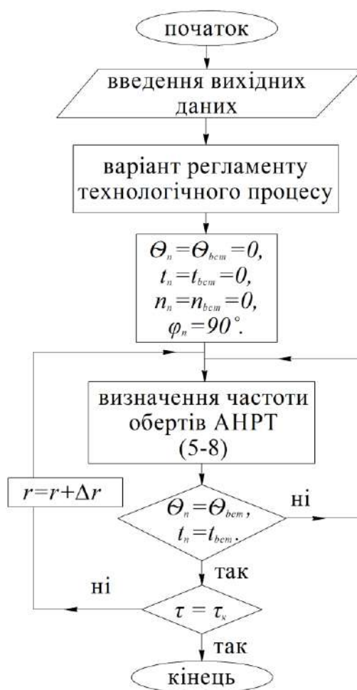
Рис. 2. Блок-схема алгоритму управління ТП БТО БВ за якісним алгоритмом
