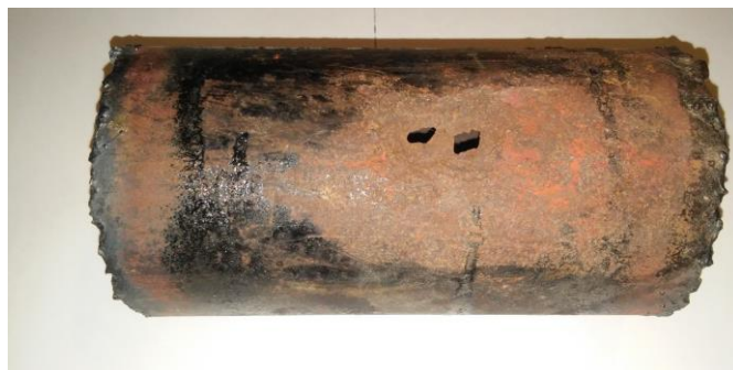
Рисунок 3 – Наскрізна корозія на газопроводі діаметром 108x4 мм
