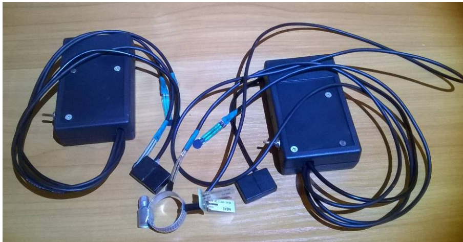
Рис. 10. Фотографія радіовимірювальної системи контролю фізичної підготовки спортсмена стрільців з луку
