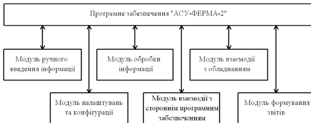
Рисунок 5.13 – Узагальнена структурна схема програмного забезпечення «АСУ-ФЕРМА-2»
