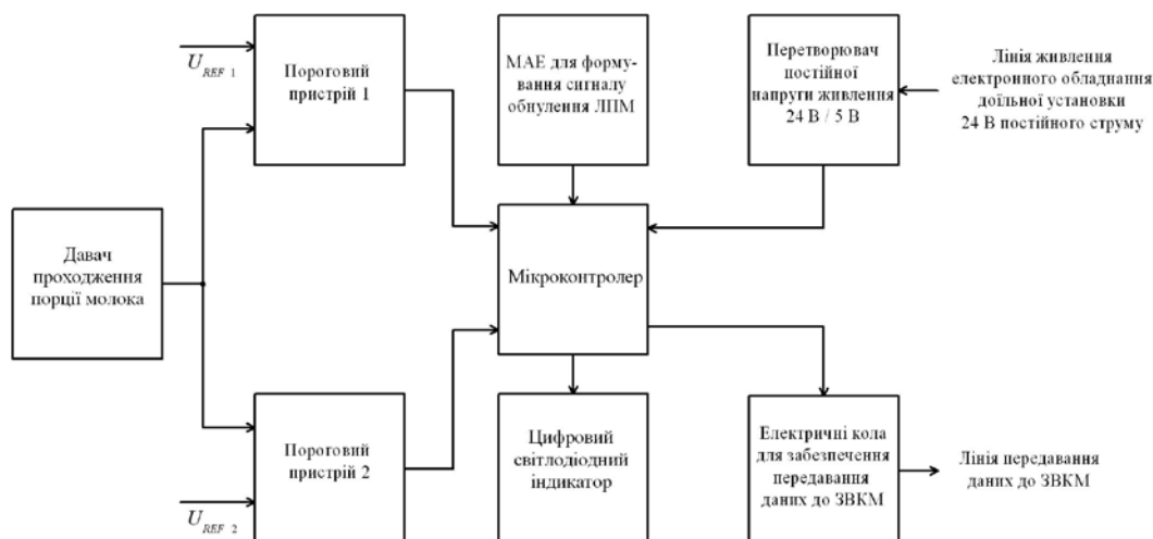
Рисунок 5.11 – Електрична структурна схема ЛПМ «СІМ-02»
