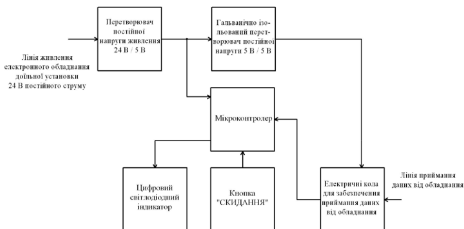
Рисунок 5.12 – Електрична структурна схема ЗВКМ «ЦНС-2»
