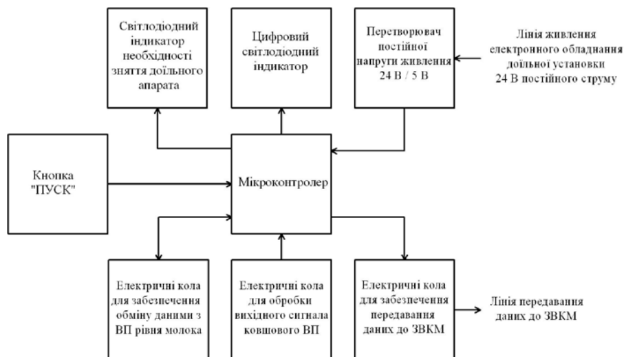
Рисунок 5.1 – Електрична структурна схема БЗПД «ІД-02»
