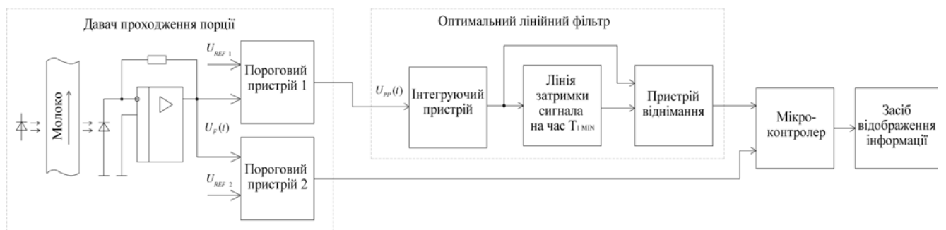
Рисунок 3.24 – Функціональна схема лічильника порцій молока для стійлової доїльної установки, з використанням оптимальної лінійної фільтрації та функцією виявлення води у молоці
