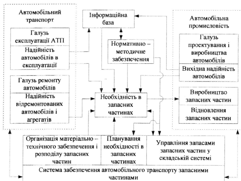
Рис. 1. Схема взаємозв'язку факторів, які впливають на формування номенклатури та кількості запасних частин автотранспортних підприємств
