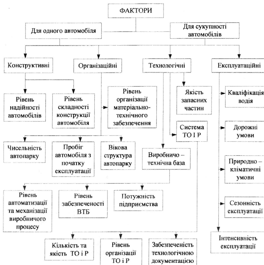
Рис. 2. Схема класифікації факторів, які впливають на формування номенклатури та кількості запасних частин автотранспортних підприємств
