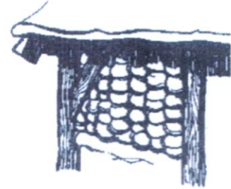
Рис. 3 Вкладання коротких вальків у стіни
