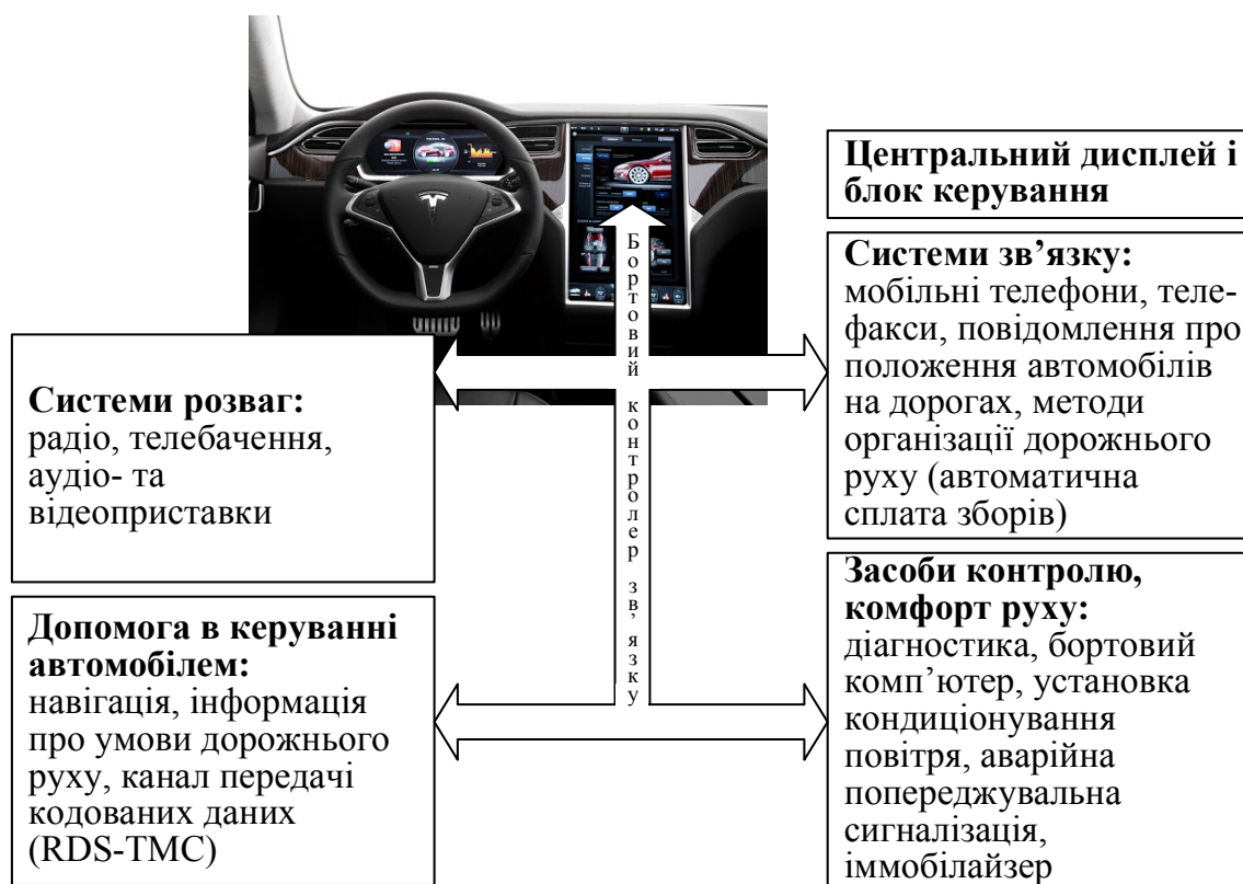
Рисунок 9.1 – Структура інформаційної системи транспортного засобу
