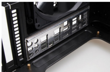
Рисунок 3.39 – Розташування заглишки корпусу відносно плати
