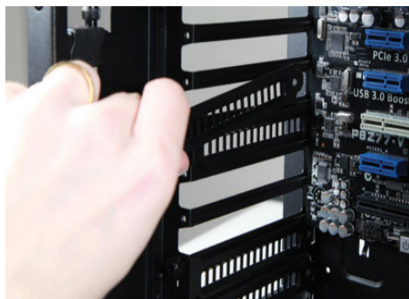
Рисунок 3.44 – Відкриття слотів корпуса
