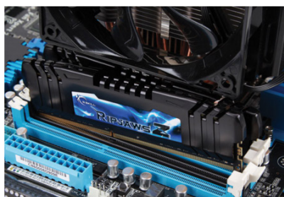
Рисунок 3.36 – Правильне розташування плати пам'яті відносно слота
