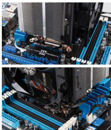
Рисунок 3.34 – Встановлення радіатора охолодження
