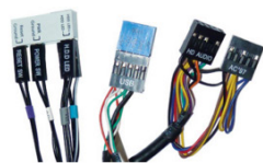
Рисунок 3.24 – Роз’єми для передньої панелі (F_PANEL)
