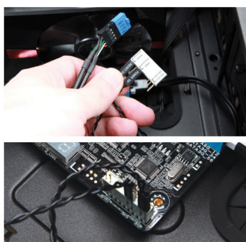
Рисунок 3.53 – Підключення проводів від передньої панелі
