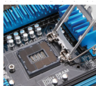
Рисунок 3.30 – Визначення розташування процесора на платі
