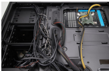
Рисунок 3.54 – Розташування кабелів у корпусі
