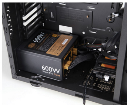
Рисунок 3.50 – Встановлення блока живлення
