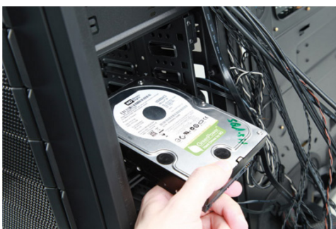
Рисунок 3.47 –Встановлення жорсткого диска
