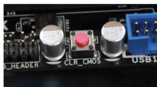
Рисунок 2.1 – Кнопка скидання BIOS
