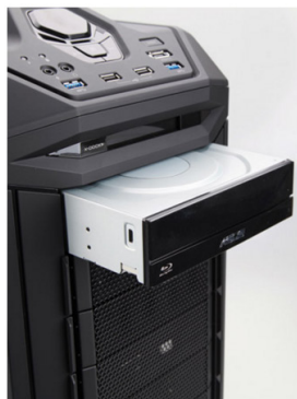
Рисунок 3.48 – Встановлення оптичного приводу
