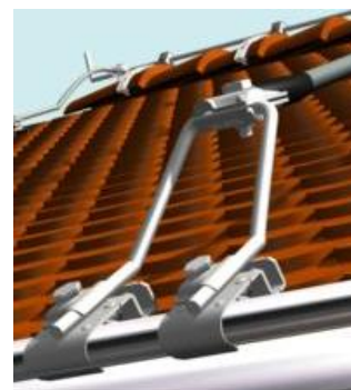
Рисунок А.16 – Клеми для з'єднання провідників з жолобами
