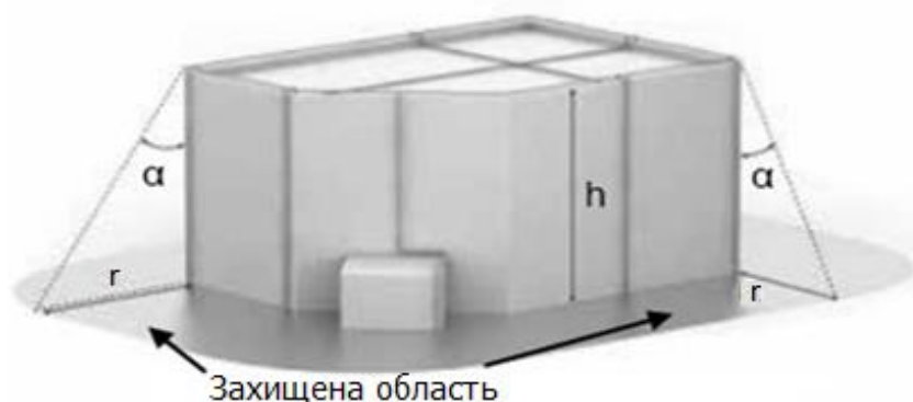
Рисунок 2.7 – Захисна зона блискавкоприймальної сітки
