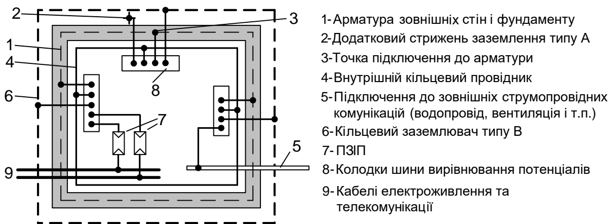
Рисунок 3.2 – Зв'язок системи вирівнювання потенціалів з внутрішнім кільцевим провідником, який з'єднує сполучні шини
