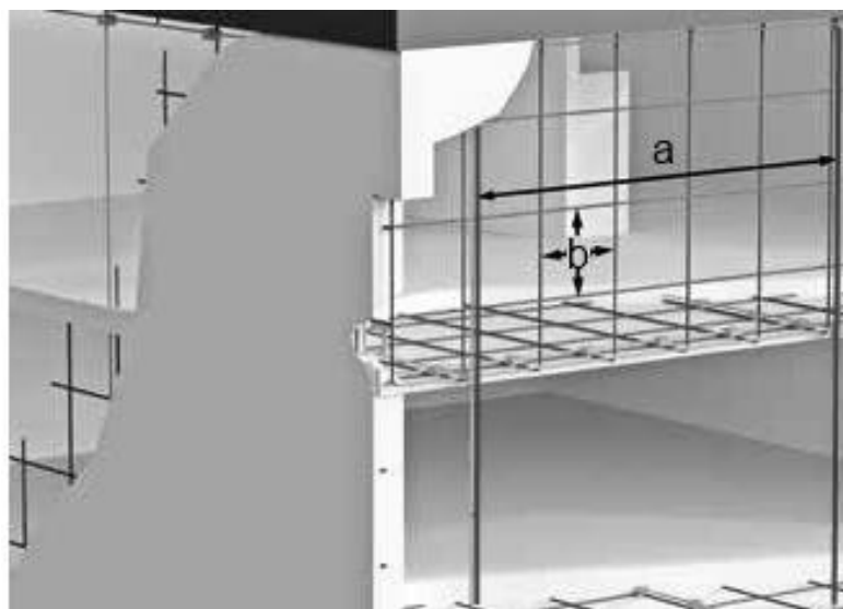
Рисунок 2.20 – Прокладка додаткових струмовідводів в бетонних стінах
