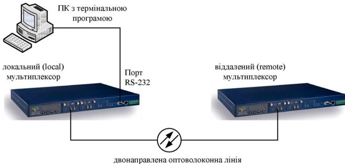
Рисунок 3.6 – Підключення ПК до ОТМ NG-PDH з топологією «точка – точка»
