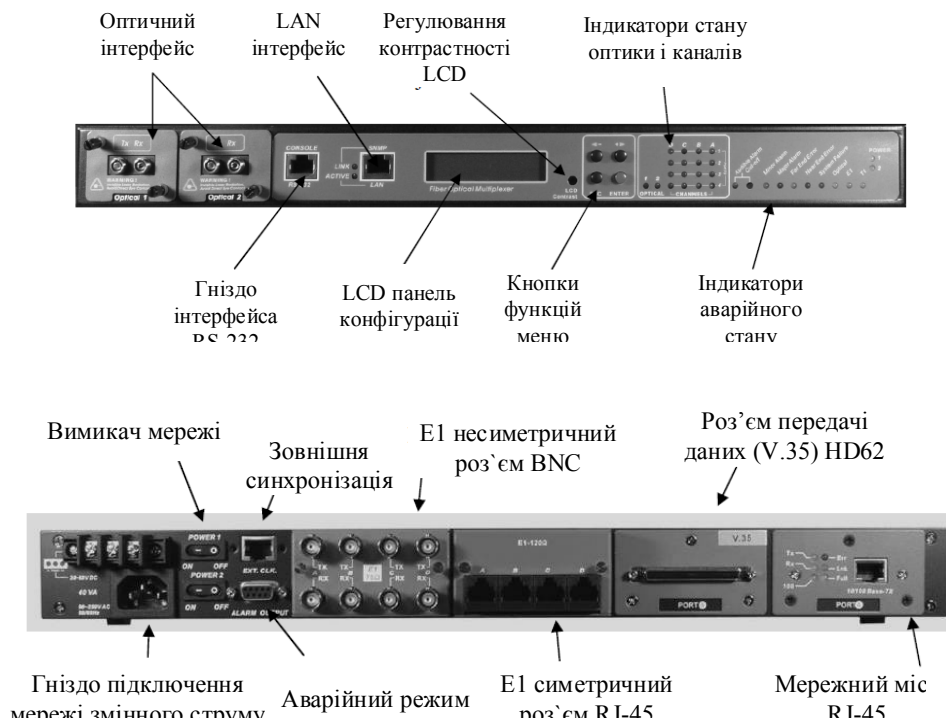
Рисунок 4.4 – Зовнішній вигляд елементів керування та інтерфейсів мультисервісної платформи FMUX-01A
