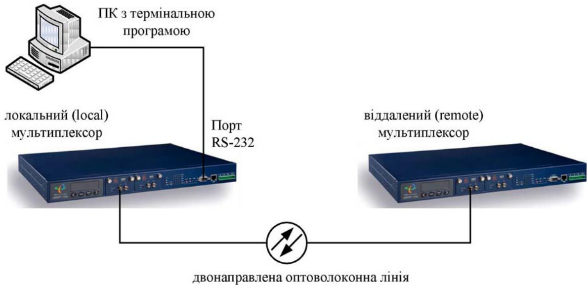
Рисунок 1.5 – Підключення ПК до OTM NG-PDH з топологією «точка-точка»
