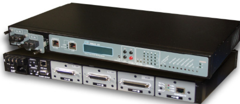
Рисунок 3.3 – Зовнішній вигляд мультисервісної платформи FMUX-01A
