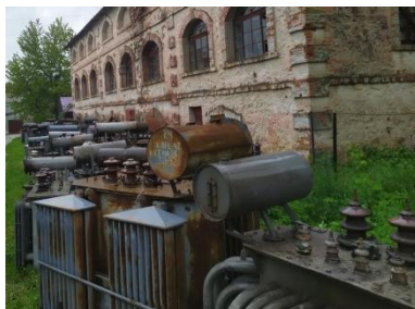
б) Відремонтвані та пошкоджені силові трансформатори 10кВ та діагностичне обладнання під час діагностування. Рис. 2 – Пошкоджені та відремонтвані силові трансформатори 10 кВ дільниці з ремонту СТ АТ «Вінницяобленерго»
