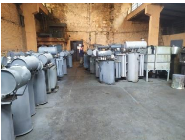
б) Відремонтвані та пошкоджені силові трансформатори 10кВ та діагностичне обладнання під час діагностування. Рис. 2 – Пошкоджені та відремонтвані силові трансформатори 10 кВ дільниці з ремонту СТ АТ «Вінницяобленерго»
