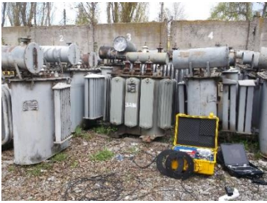
а) СТ 10 кВ, що вийшли з ладу, на зберіганні до ремонту та прилад для аналізу їх технічного стану FRAnalyzer.
