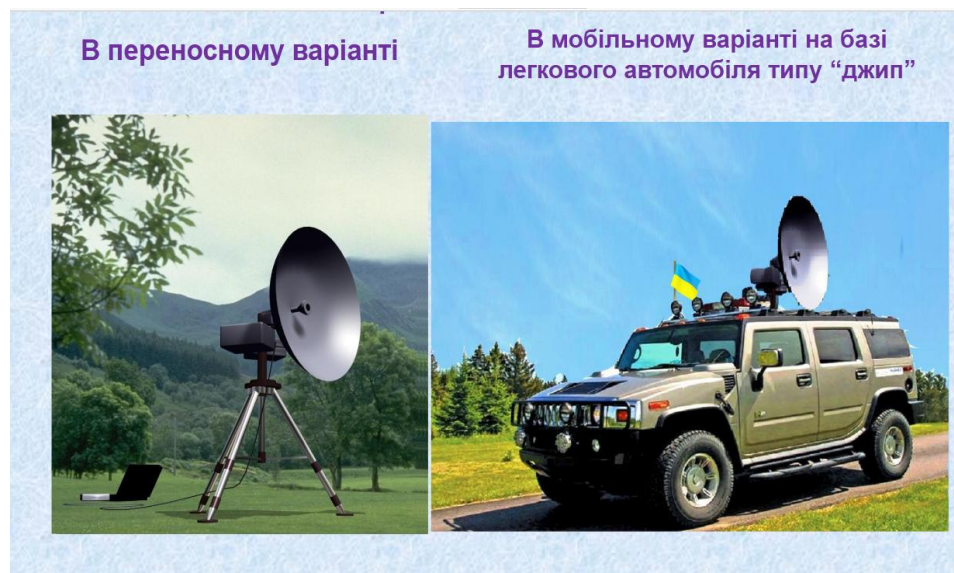
Рисунок 2. Малогабаритна тропосферна радіорелейна станція нового покоління.
