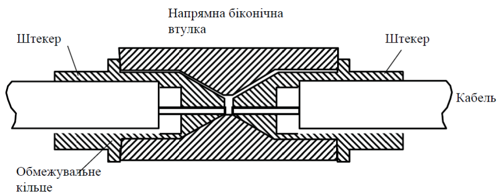
Рисунок 4.21 – Розріз конструкції з'єднувача з конічною втулкою
