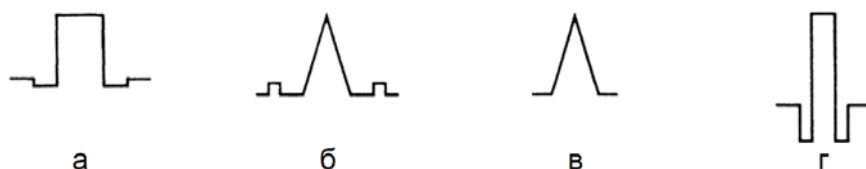
Рисунок 4.40 – Типи профілів показника заломлення осердя ООВ
