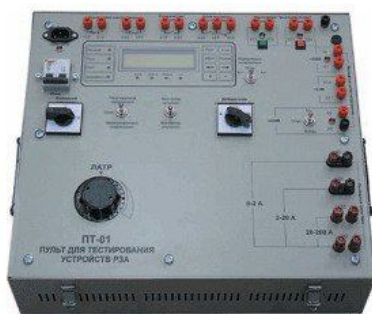
Рисунок 5.2 – Пульт для тестування захистів ПТ-01
