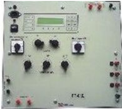
Рисунок 5.4 – Додатковий блок фазорегулятора ПТ-01Д
