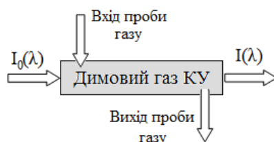
Рисунок. 3 – Модель ослаблення випромінювання в середовище димових газів котельних установок
