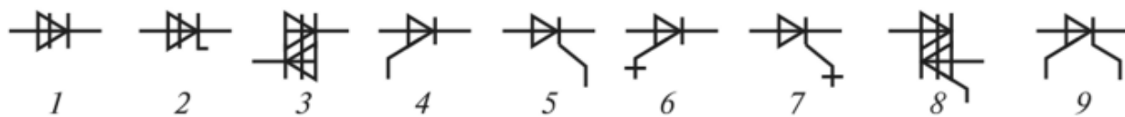
Рисунок 6.3 - Позначення тиристорів на електронних схемах
