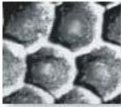
Рис. 4. Гравірований лазером керамічний растрований циліндр
