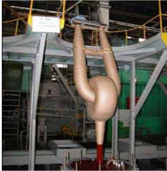
Рисунок 2.9 – U-подібна первинна обмотка
