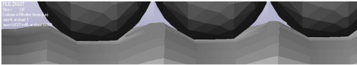
Рис. 1 . Утворення пластичної хвилі перед роликом та після нього на поверхні деталі
