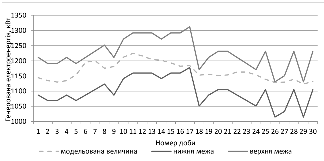
Рисунок 3 – Виміряні та прогнозовані результати добового генерування електроенергії МГЕС «Топольки»
