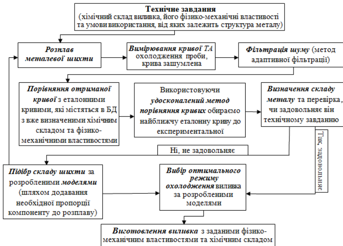
Рис. 1 – Схема корегування складу металу, його структури та властивостей вилівка за результатами програмної обробки результатів термоаналізу (ТА) [2].
