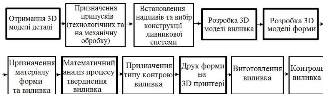
Рисунок 3 – Схема розробки ливарного процесу з 3D друком ливарної форми.
