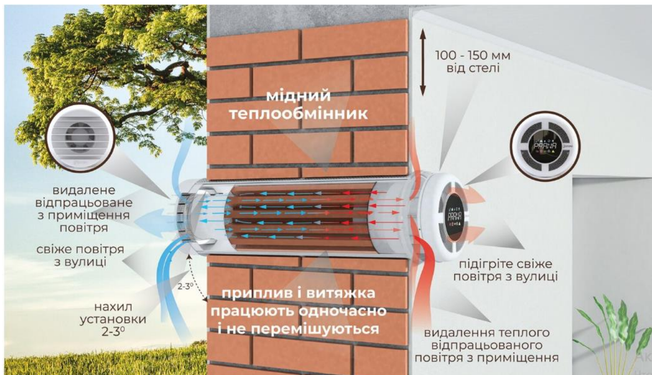
Рис. 1 – Схема роботи системи вентиляції із мідним теплообмінником [1, 2]
