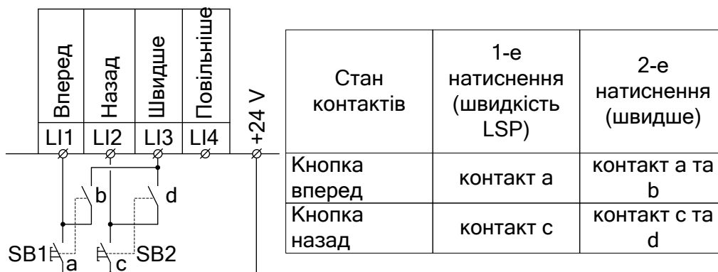
Рисунок 8.7 – Схема підключення автоматичного потенціометра
