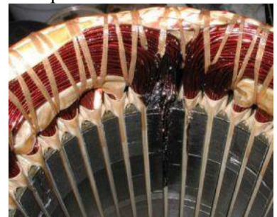
Бандажна стрічка пошкоджена біля згорілої обмотки
