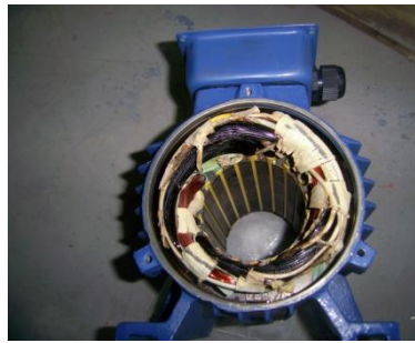
Бандажна стрічка пошкоджена біля згорілої обмотки
