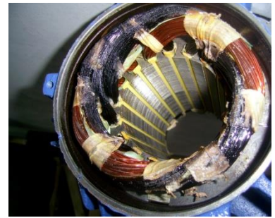
Бандажна стрічка пошкоджена біля згорілої обмотки
