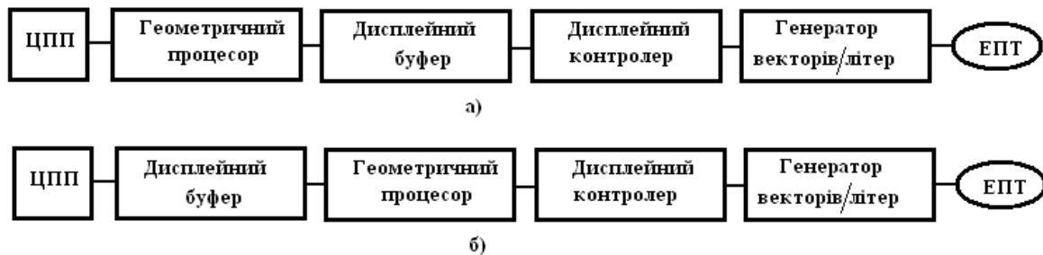
Рисунок 5.4 – Концептуальні блок-схеми векторних дисплеїв з регенерацією
