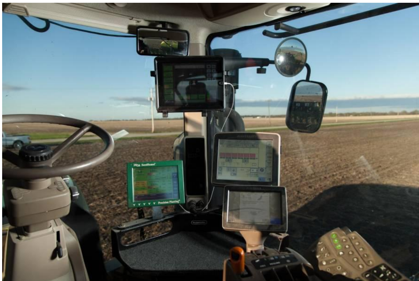
Рис. 1. Комбайн з системою зі зчитуванням даних про вологість ґрунту та мікроклімату для оптимальної збирання врожаю на полі
