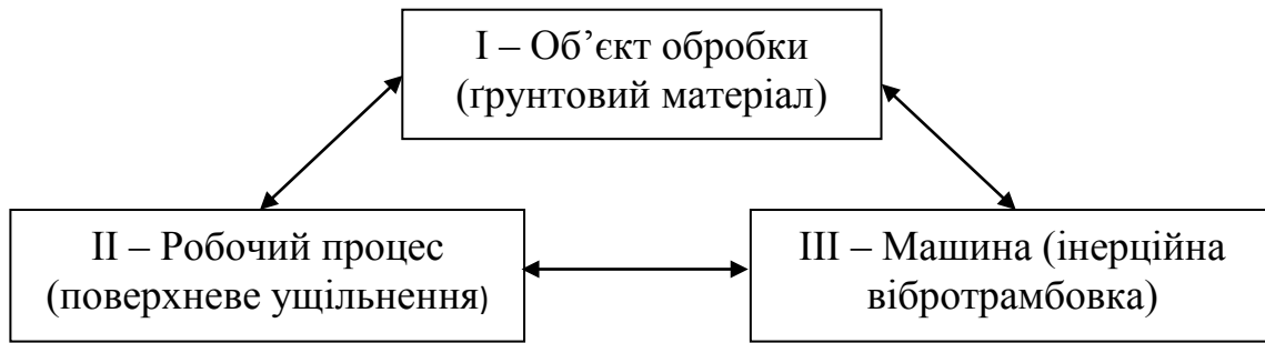
Рисунок 3.9 – Структурна схема технологічного комплексу поверхневого віброущільнення ґрунтів
