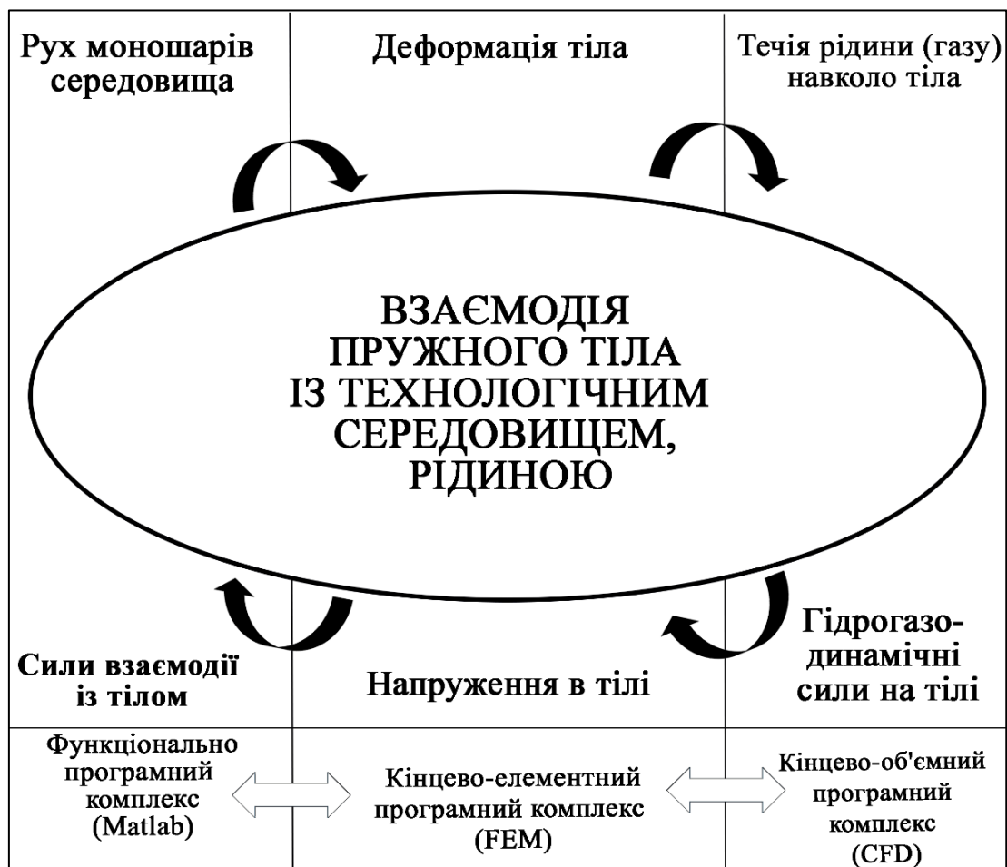
Рисунок 6.2 – Структурна схема інтегровано-розрахункового середовища FSI
