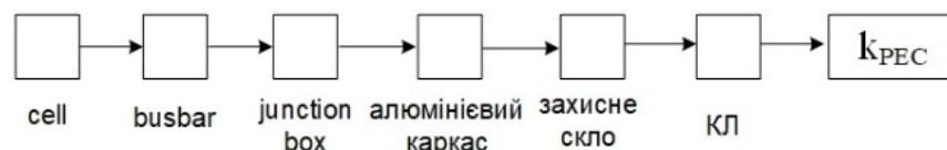
Рисунок 4.12 – Структурна схема моделі коефіцієнта залишкового ресурсу ФЕМ
