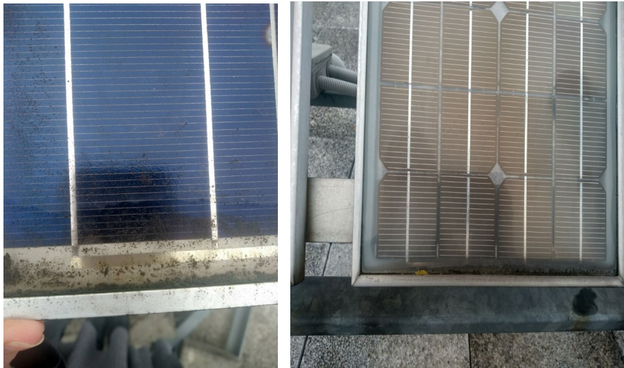
Рисунок А.11 – Пошкодження герметика ФЕМ та склопакету
