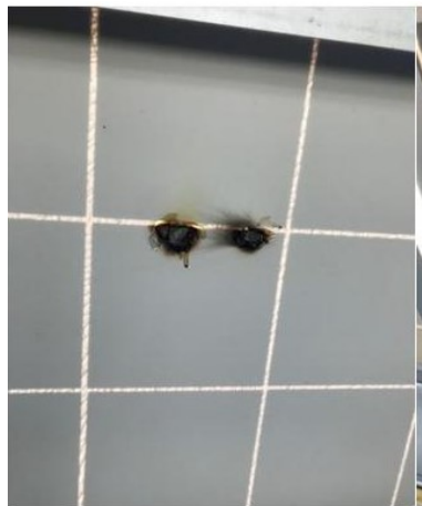
Рисунок А.13 – Зростання опору та нагрів контактів в місці з'єднання sell з busbar ФЕМ
