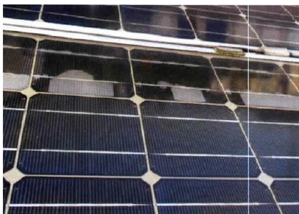
Рисунок А.1 – Розшарування та деградація cells ФЕМ
