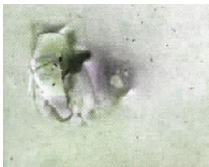
Рисунок А.4 – Пошкодження EVA (пошкодження етилен-вінілацетатового покриття ФЕМ)
