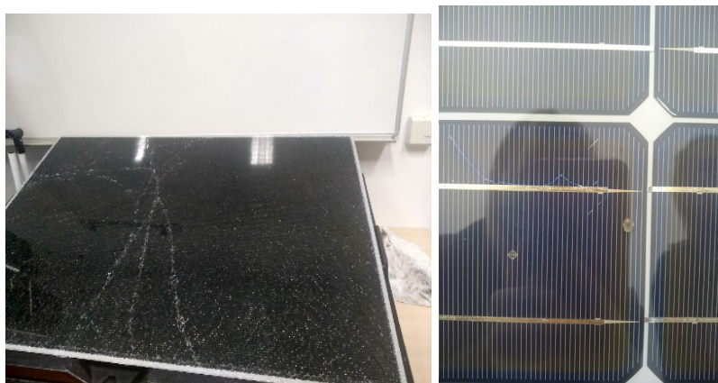
Рисунок А.9 – Тріщини на захисному склі ФЕМ
