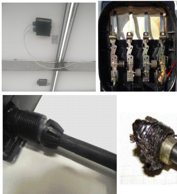
Рисунок А.15 – Клемний термінал junctionbox – місце можливого перегріву
