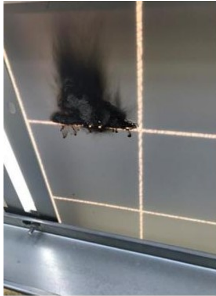
Рисунок А.14 – Зростання опору та нагрів контактів в місці з'єднання sells між собою або пошкодження діоду Шоттки
