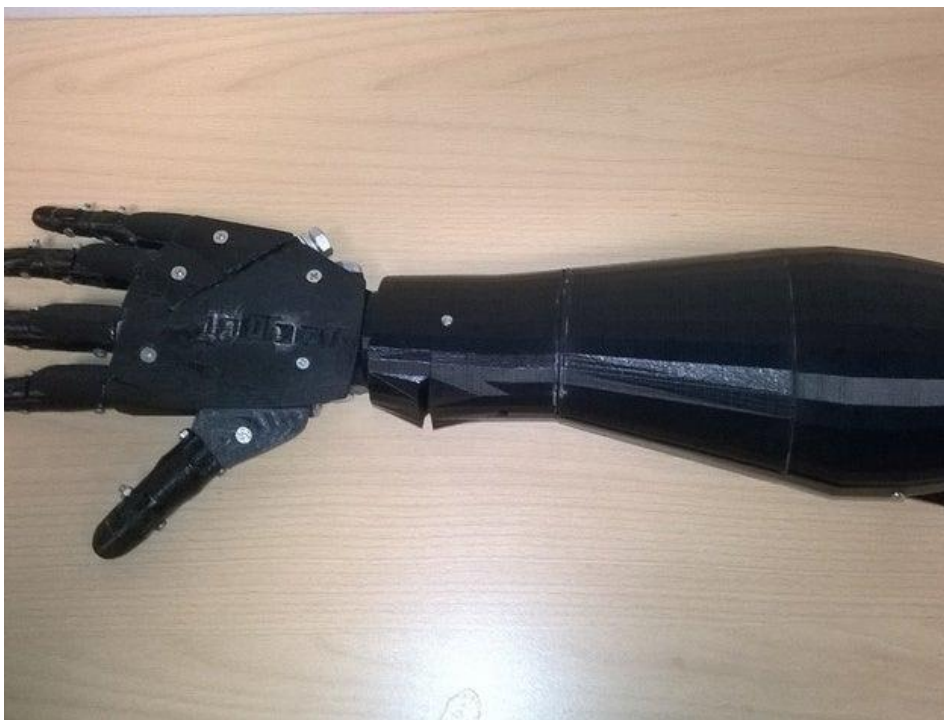
Рисунок 1 – Прототип електромеханічного протезу передпліччя
