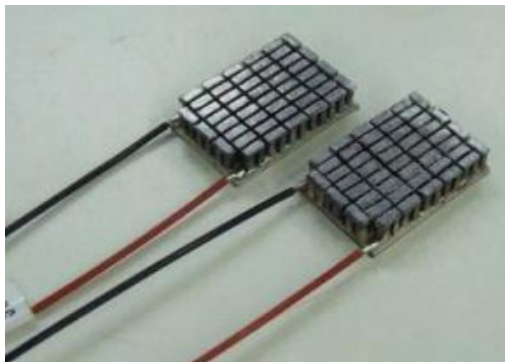
Рисунок 4 - Перші модулі ТЕ з використанням нових сегментованих елементів LAST / LASTT / телуриду вісмуту [6].
